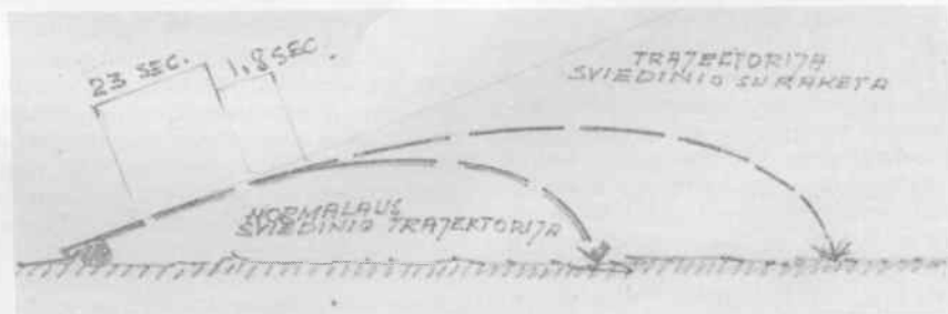
105 mm pabūklų sviedinio raketa veikia 1.8 sekundės, po 23 sekundžių palikus vamzdį.
